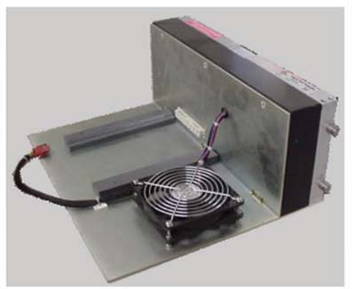
Test Fixture with a Fan to test UUT Fan Output
